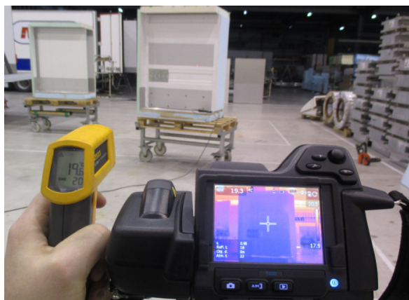
7 pav. Kėbulo izoterminės pertvaros su terminiu atskyrimu terminio tyrimo eiga – atliekamas antrasis bandymas
