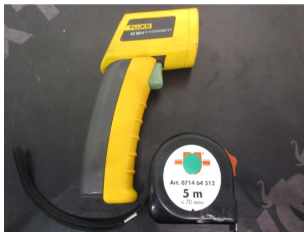
3 pav. Skaitmeninis pirometras FLUKE 62 MINI ir ruletė
