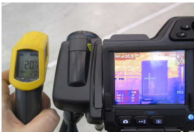
2 pav. Termovizoriaus kalibravimas – naudojant pirometrą sulyginamas spinduliavimo koeficientas \epsilon
