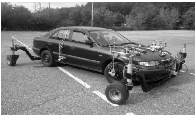
1 pav. Automobilis „Mazda 626“ ant slydimą imituojančios sistemos su sumontuota matavimo įranga
