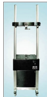
2 pav. Amortizatorių bandymo stendas „Shock Absorber Dynamometer Clubman 04“
