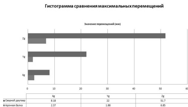
Рис. 8. Гистограмма сравнения максимальных значений перемещений
