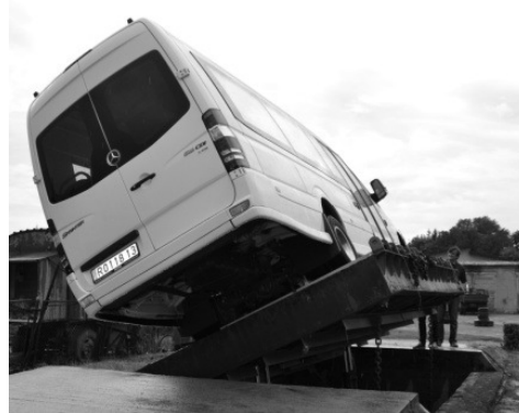
1 pav. Stovumo tikrinimo stendas (plokštuma pakreipta 28° kampu)
